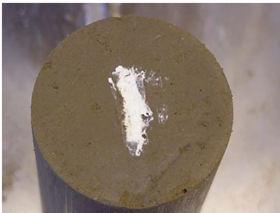
Figur 2. Gipsfylld skåra i provkropp.
