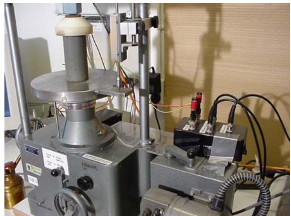
Figur 3. Provkropp placerad i tryckmaskinen.
