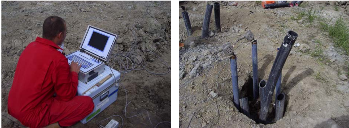
Figur 13 a-b. Ultrasonicmätning i pelare A8.
