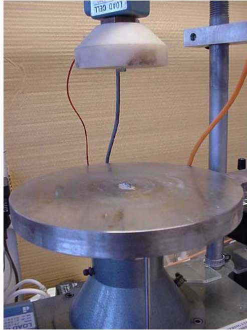
Figur 1. Böjelementen fästs i undre och övre tryckplattan på tryckmaskinen.
